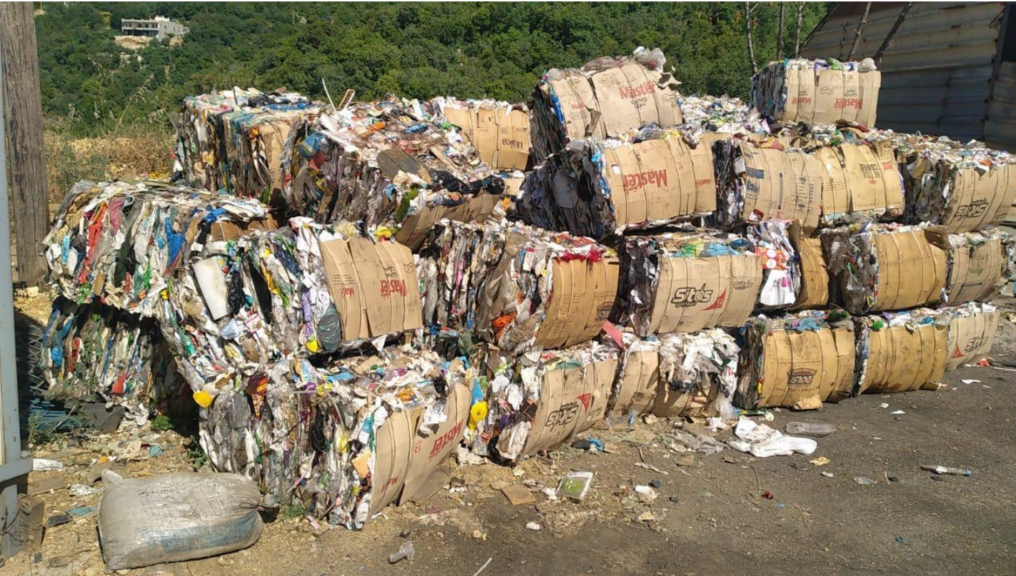
تجميع العوادم بعد فرزها وتحويلها الى مكعبات
