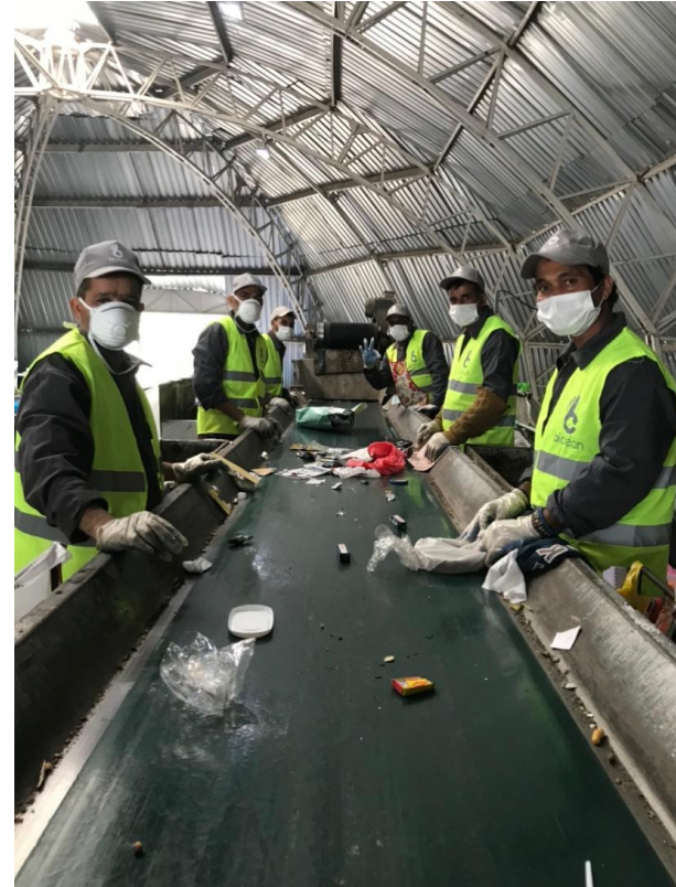
عند امتلاء الأكياس تنقل إلى المختبر على المواد تمهيداً لنقلها لإعادة التدوير المواد على الحزام الناقل المتحرك حيث يفصل كل مادة على حدة ووضعها في أكياس
